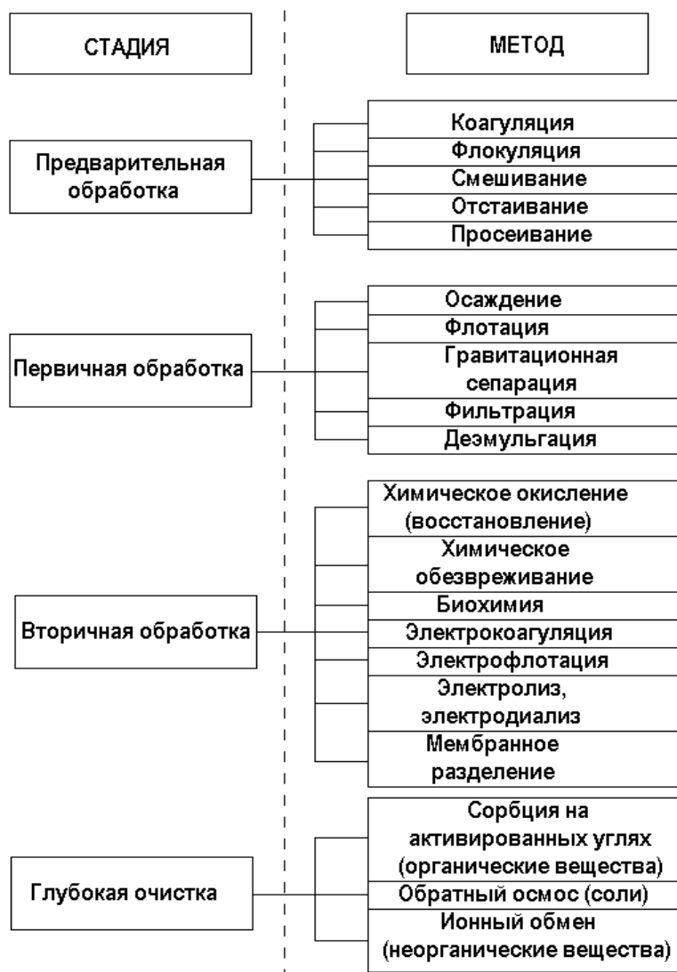
Рисунок 2 – Стадии техпроцесса обработки сточных вод производственного предприятия
